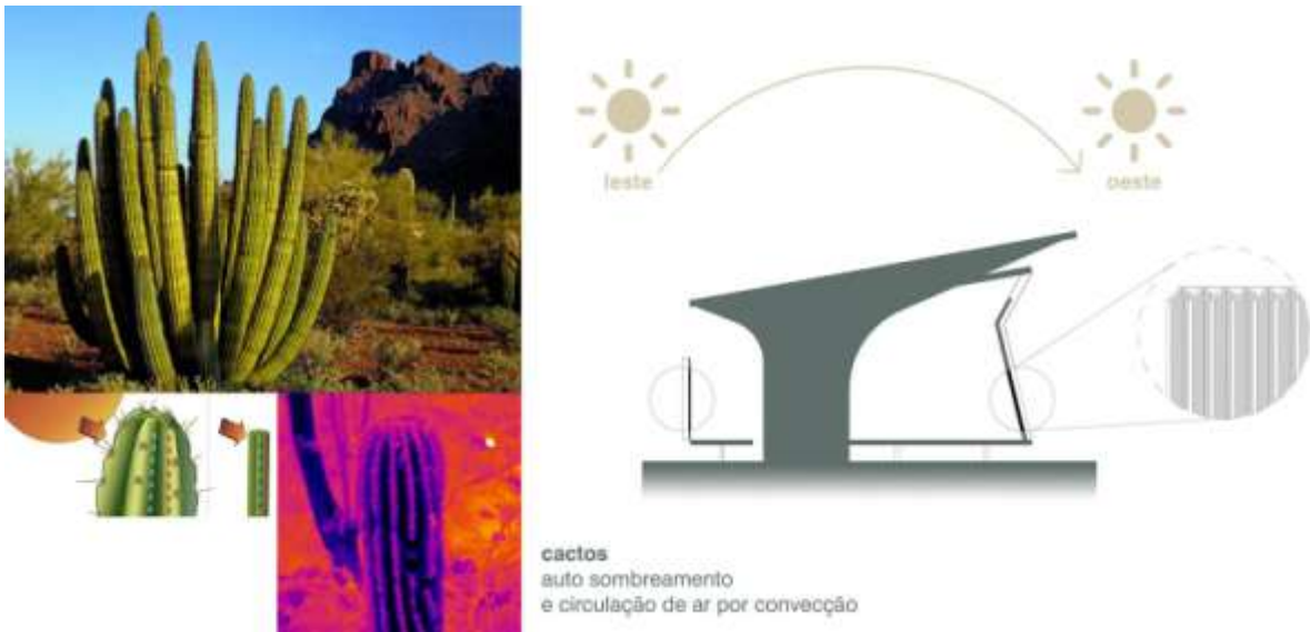
Figura 18 Sistema de auto-sombreamento inspirado nos cactos
