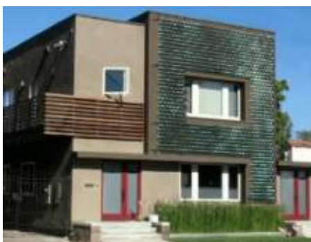
Figura 15 Placas SolarIvy aplicadas em uma fachada
