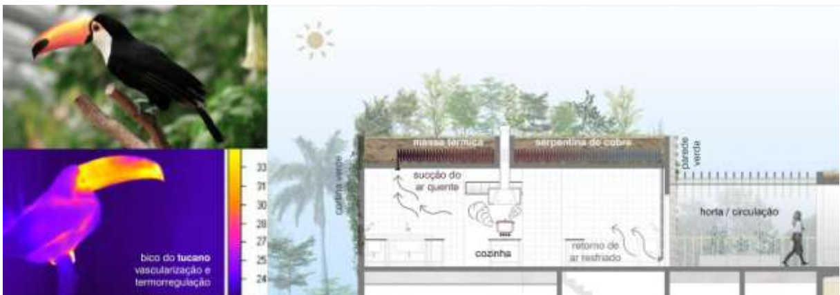
Figura 19 Sistema de troca de calor inspirado no bico dos tucanos
