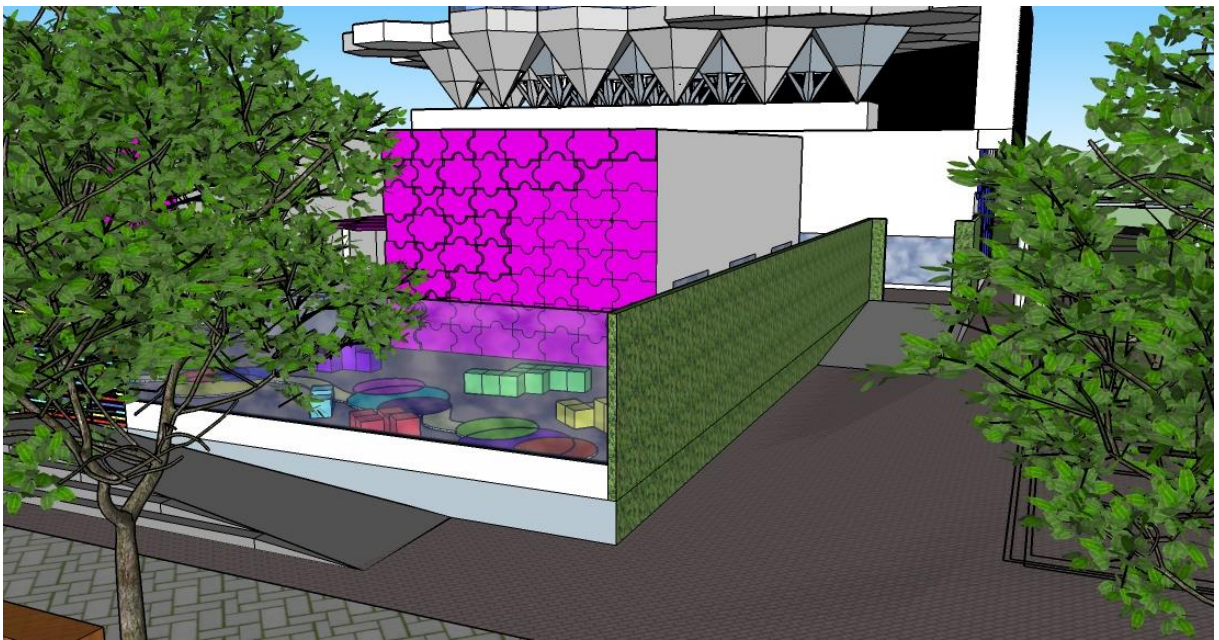
Figura 58 Cobertura Externa com painéis metálicos e brises do bloco 2. Fonte: autora.
