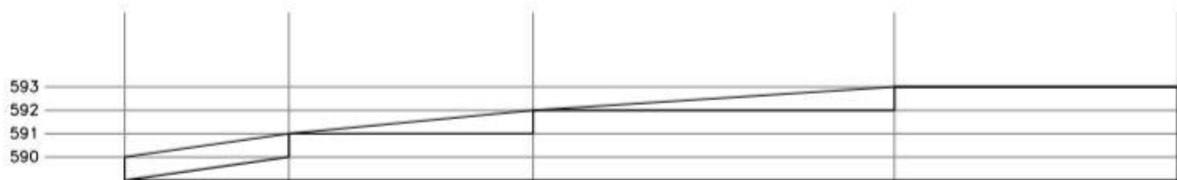
Figura 80 - Perfil longitudinal do terreno (esc. 1:200).
