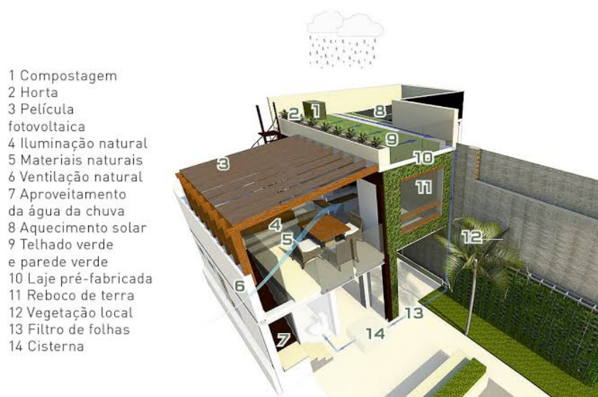
Figura 1: Esquema de Arquitetura bioclimática Fonte: ArcWeb. Disponível em: https://www.arcoweb.com > Acesso em 5 nov.2019.
