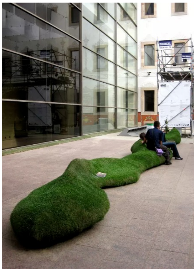
Figura 9: foto Banco biodigital feito de madeira, poliestireno e grama. Um software modela e uma máquina computadorizada constrói a peça de uso público em Barcelona, Espanha. Projeto tipicamente orgânico, criação dos espanhóis Alberto T. Estévez, Alejandro Muiño e Diego Navarro. Fonte: Entrevista à Casa Vogue de William Myers, autor do livro: Biodesign: Nature +Science+Creativity. https://casavogue.globo.com/Design/noticia/2013/09/mestre-do-biodesign-fala-casa-vogue.html
