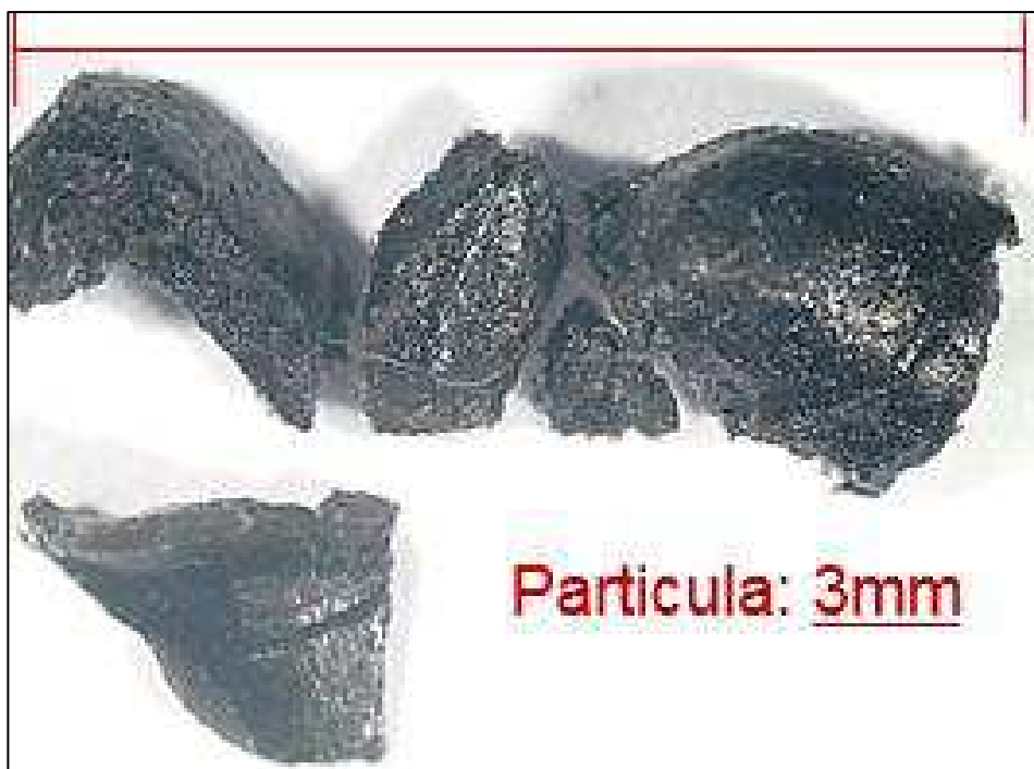
Figura 13 – Dimensionamento da partícula. (Utilizando Microscópio óptico)
