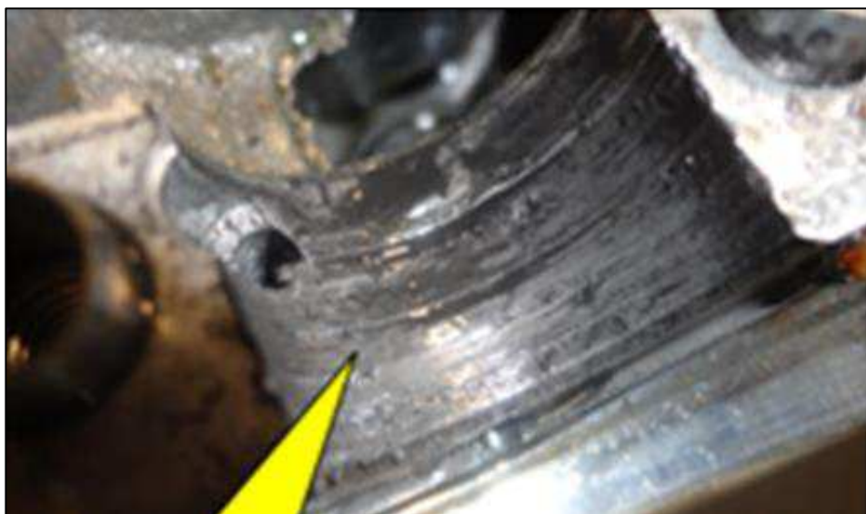
Figura 11 – Desgaste no mancal 3 do eixo do comando.
