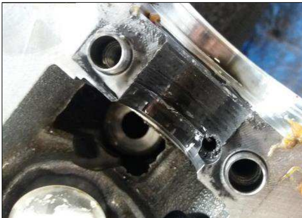
Figura 10 – Vista superior do desgaste nos mancais do eixo de comando.
