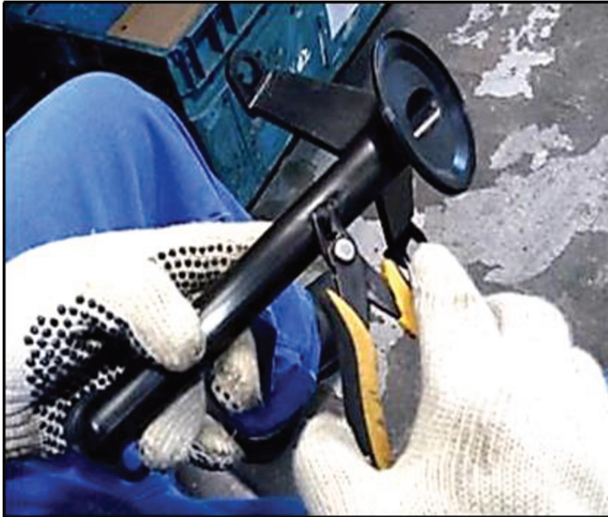
Figura 20 – Processo de remoção do ponto de injeção plástica.
