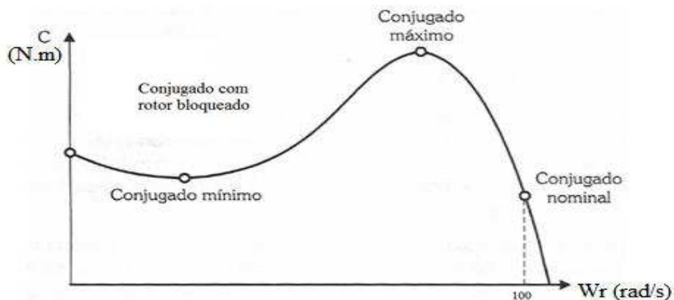
Figura 5- Curva típica velocidade x torque
