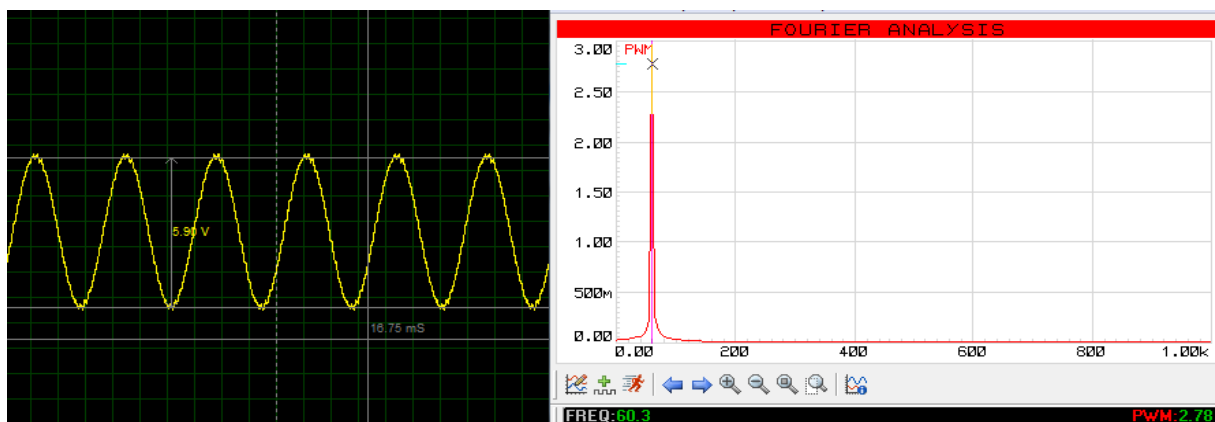
Figura 43- Resultado da simulação do sinal de 60Hz para uma das fases
