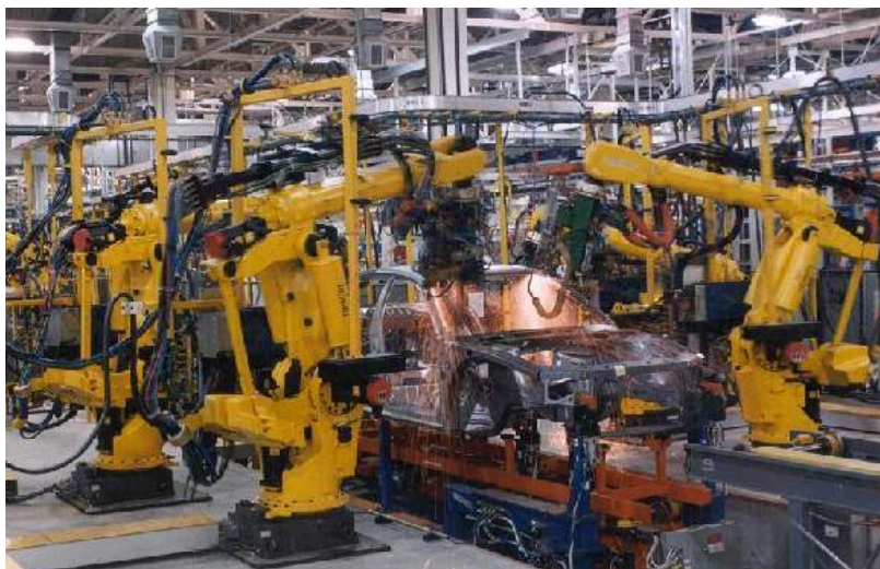
Figura 02. Armação de Carroçaria Fonte: AUTOR (2016)
