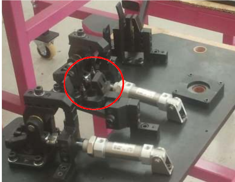
Figura 31. Detalhe de exemplo de POKAYOKE construído Fonte: AUTOR (2016)
