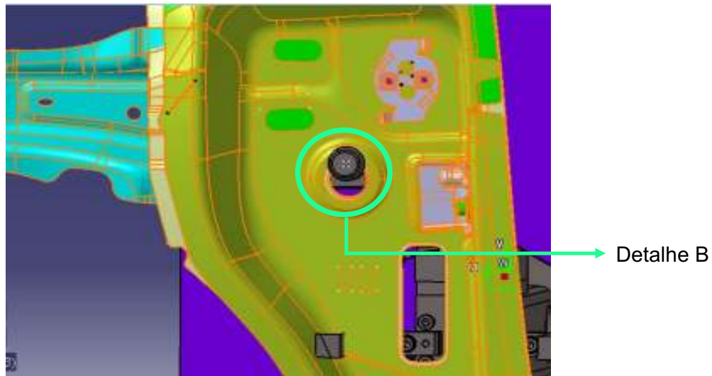
Figura 38. Interferência 2 entre produto e sistema de posicionamento Fonte: AUTOR (2016)
