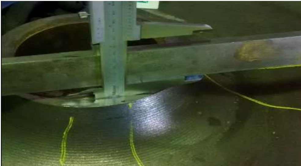
Figura 14: Medição da cota R2 com paquímetro e régua.
