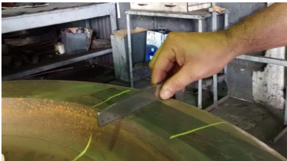
Figura 13: Medição da cota G1 com o gabarito.
