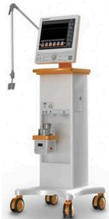
Figura 22: Um ventilador pulmonar para UTI típico Fonte: ANVISA (2016)
