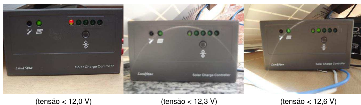
Figura 7.4 – Indicação das tensões dos LED's do Controlador de Carga Fonte: Autor
