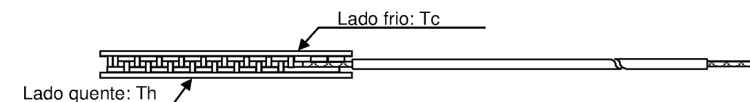
Figura 4.2: Vista lateral do módulo termoelétrico Fonte: Thermonamic Electronics, 2012 (adaptada pelo autor)
