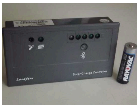
Figura 7.2: Controlador de carga Landstar com sistema de monitoramento Fonte: Autor
