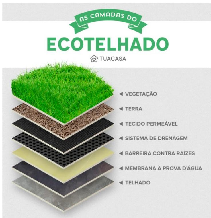
Figura 65 - Detalhamento do Ecotelhado
