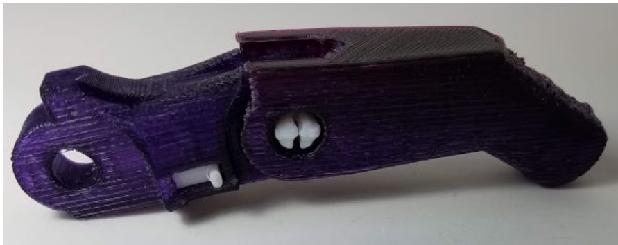
Figura 8-3 - Montagem do dedo do protótipo DAH – Vista Frontal Fonte: Próprio autor
