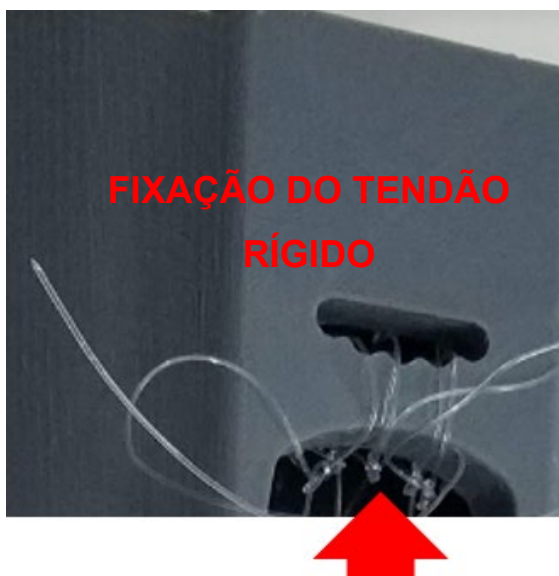
Figura 8-14 – Fixação dos tendões rígidos na Manopla do protótipo DAH Fonte: Próprio autor
