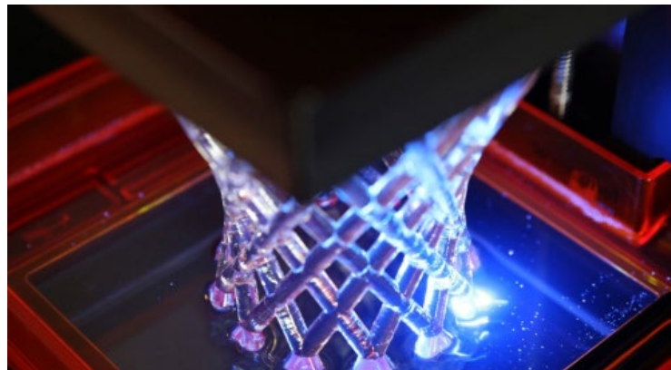
Figura 4-4 – Foto da construção real de uma peça com a técnica SLA Fonte: RapidParts (2018)
