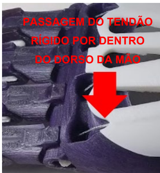
Figura 8-13 – Passagem do fio de nylon para fixação do tendão rígido no protótipo DAH Fonte: Próprio autor
