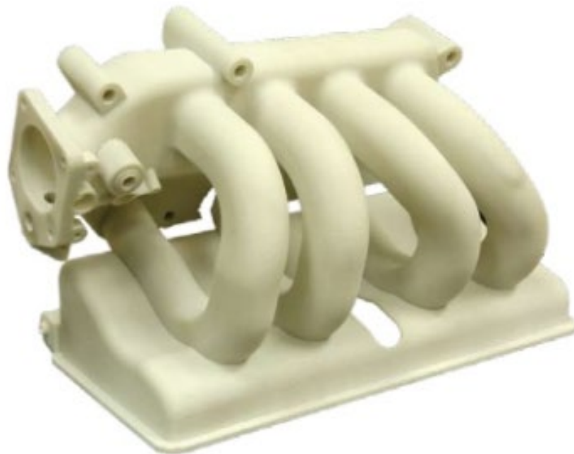
Figura 4-6 - Ilustração de um conjunto dutos de motor a combustão interna construído com a técnica SLA
