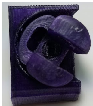
Figura 7-6 - Componente de rotação do polegar do protótipo DAH Fonte: Próprio autor
