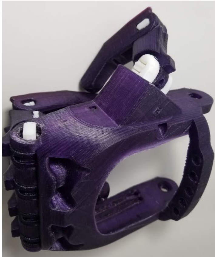
Figura 8-8 - Montagem da mão do protótipo DAH Detalhe do componente de rotação do polegar Fonte: Próprio autor
