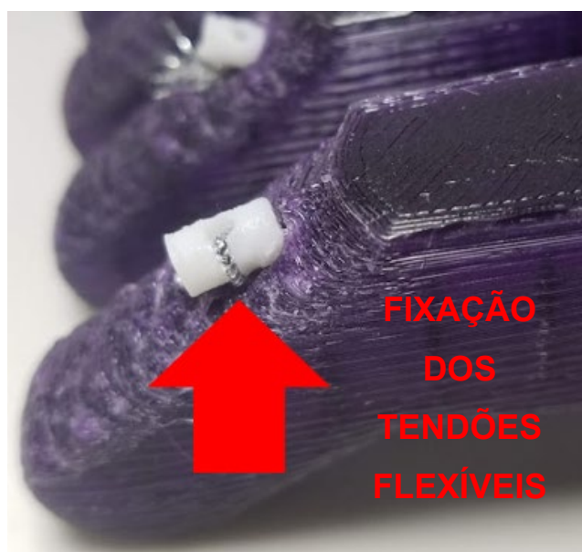
Figura 8-15 – Fixação dos tendões flexíveis (elásticos) do protótipo DAH Fonte: Próprio autor
