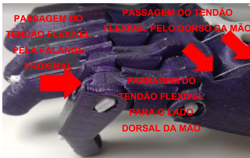
Figura 8-16 – Passagem dos tendões flexíveis (elásticos) do protótipo DAH Fonte: Próprio autor
