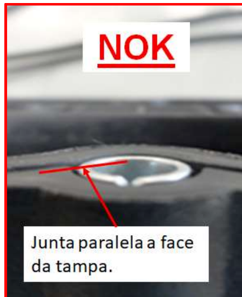
Figura 23 - Foto de uma tampa do comando que vazou em garantia
