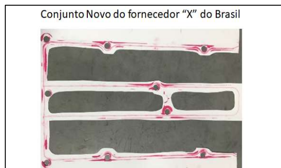
Figura 33 - Revelação do teste de compressão FUJI para o conjunto da tampa nacional nova
