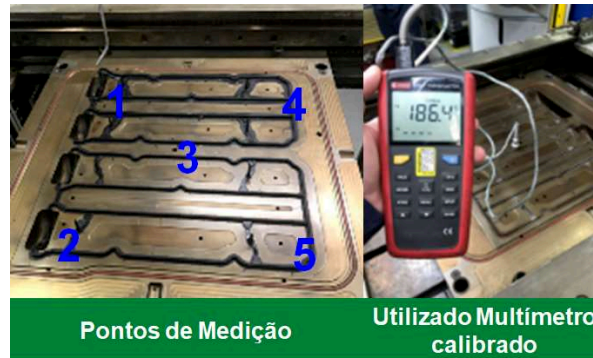
Figura 31 - Ilustração dos pontos da temperatura do molde de injeção da junta
