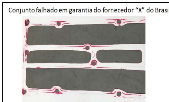
Figura 35 - Revelação do teste de compressão FUJI para a tampa do comando nacional de garantia
