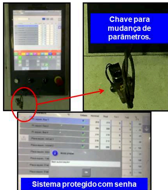
Figura 41 - Chave e senha implementados no painel para restringir os parâmetros da temperatura de injeção a somente a engenharia de manufatura de processos
