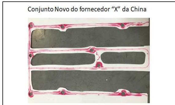
Figura 34 - Revelação do teste de compressão FUJI para o conjunto da tampa da China nova
