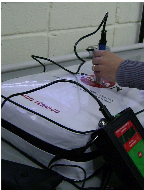
Figura 18 – Medições com acelerômetro na almofada térmica vibratória
