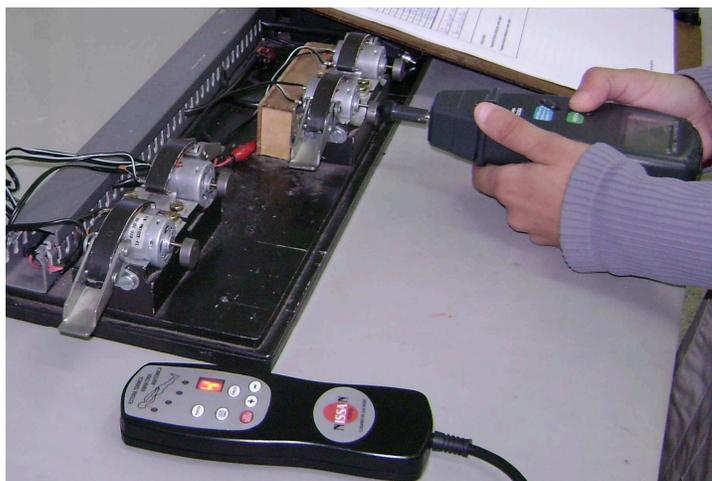
Figura 19 – Medições com tacômetro na esteira térmica anatômica vibratória
