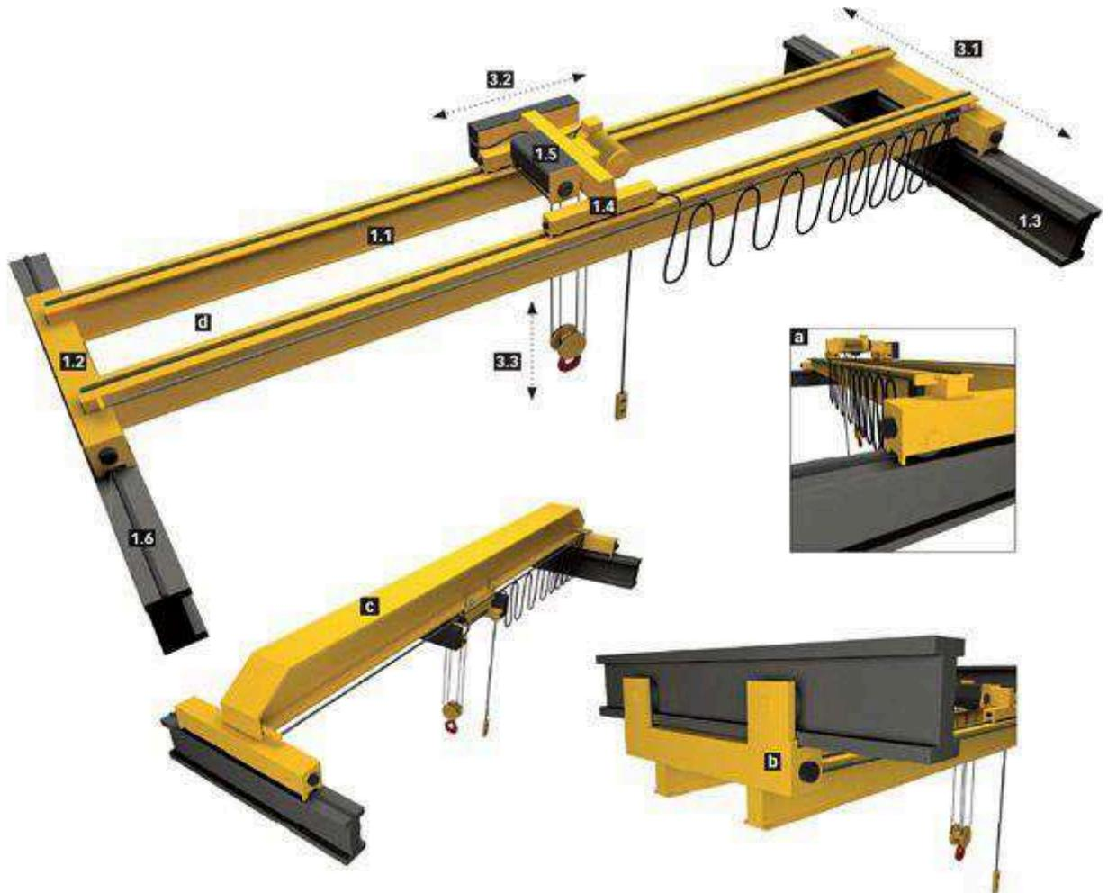
Figura 1 – Ilustração de uma ponte rolante
