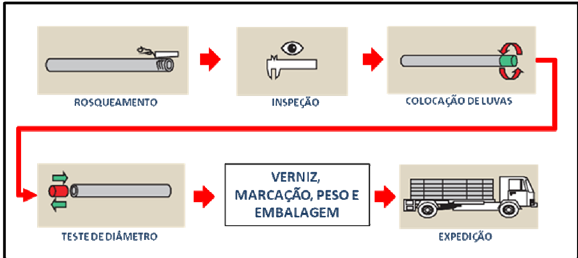
Figura 13 – Processo de rosqueamento dos tubos, galpão C
