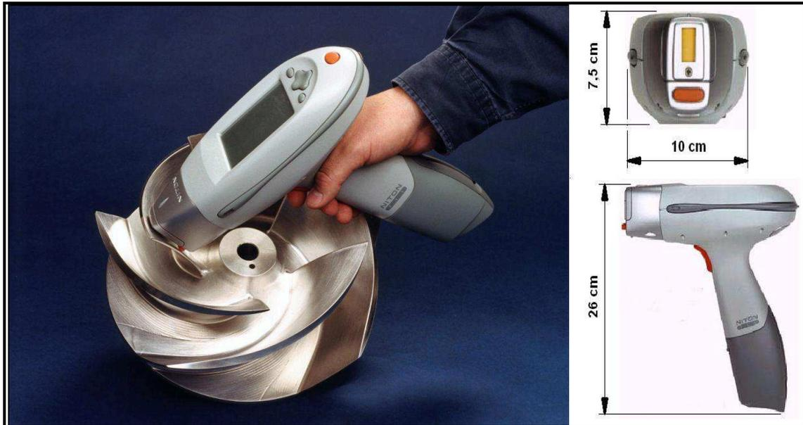
Figura 3.4 – Ensaio de PMI por meio da fluorescência de raios X.
