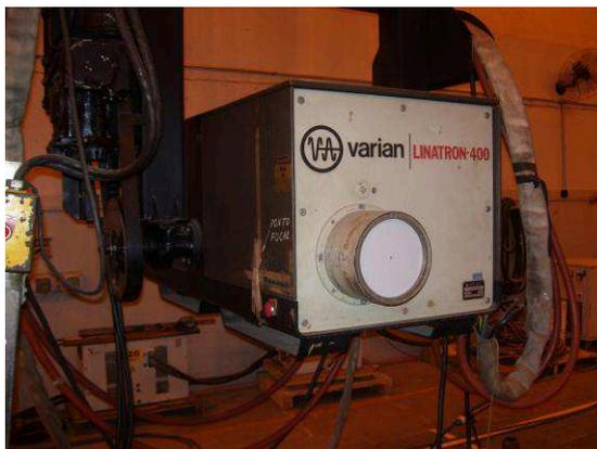
**Figura 3.25** – Acelerador linear Varian modelo Linatron 400 da Confab.
