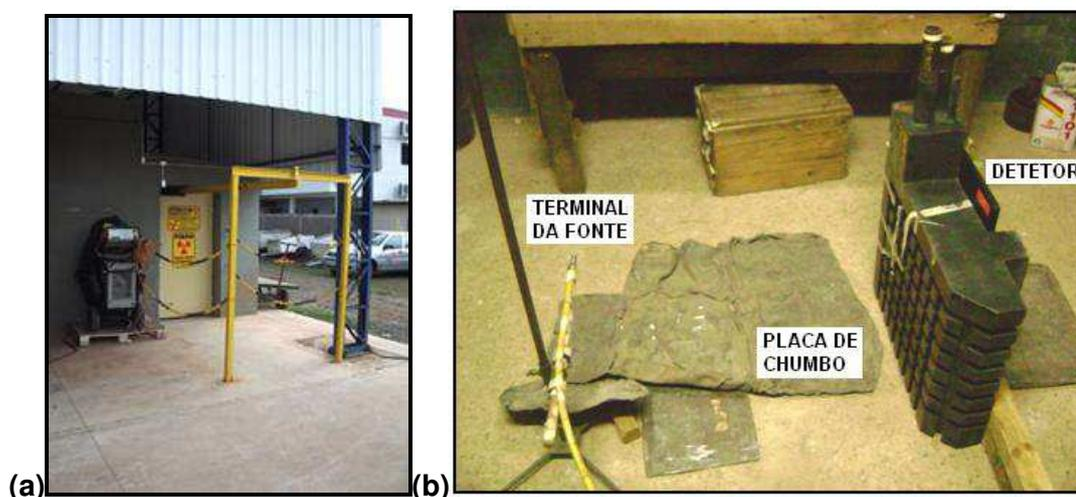
**Figura 3.29** – (a) Bunker da Arctest, área de exposição de 3,0 x 3,0 (b) Arranjo para ER.
