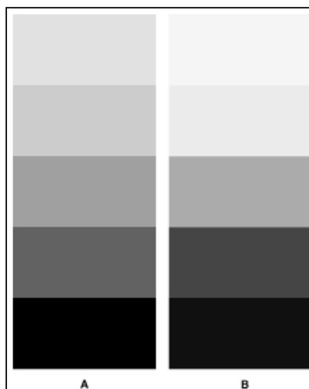
**Figura 2.8** – Contraste radiográfico – Exposição (A) 220 kV, (B) 120 kV [26].
