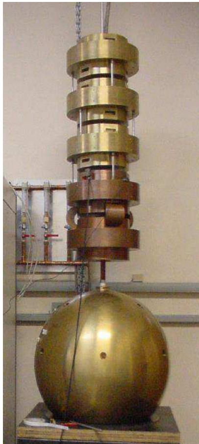
Figura 3 - Foto real da esfera com as cinco massas ressonantes
