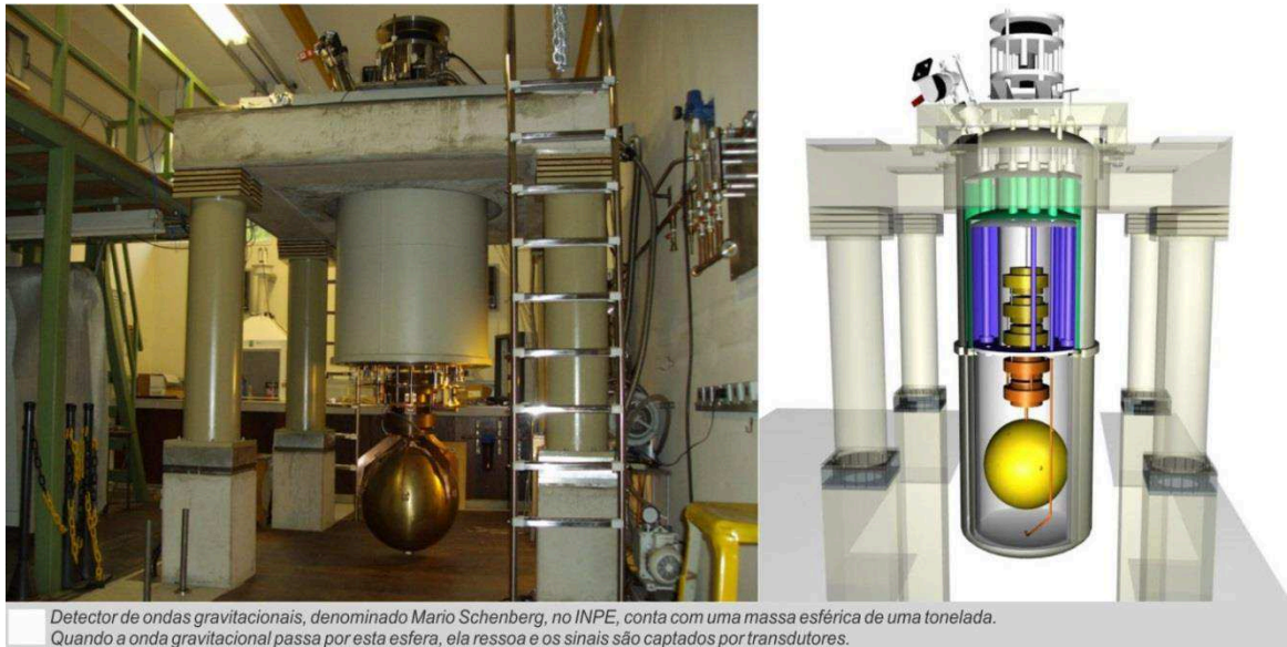
Figura 1 - O detector de ondas gravitacionais, Mario Schenberg
