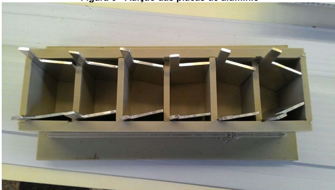
Figura 6 - Adição das placas de alumínio
