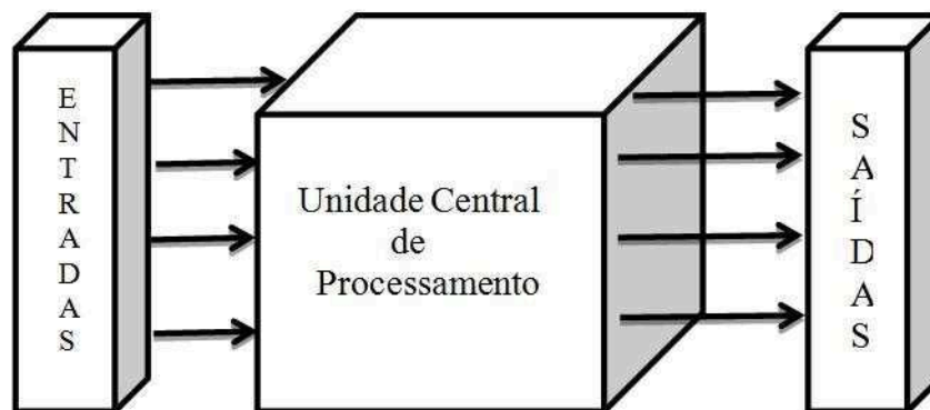
Figura 3 - Arquitetura da CPU do CLP. FRANCHI e CAMARGO (2008)
