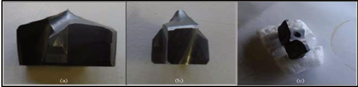
Figura 24 - (a) arestas de corte do inserto sobre a superfície de saída. (b) vista lateral do inserto e (c) vista da parte posterior do inserto por onde é fixado no suporte, diâmetro da broca é de 19,27mm.
