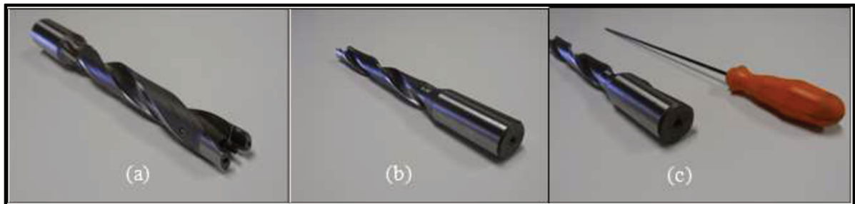
Figura 25 – Suporte da ferramenta: (a) ilustração do suporte da ferramenta sem o inserto, (b) ilustração do furo na parte de trás do suporte que dá acesso ao parafuso que prende o inserto, (c) ilustração da ferramenta utilizada para fixação do inserto no suporte. Não foram apresentadas as escalas porque são fotos ilustrativas da broca. O diâmetro da broca é de 19,27 mm.
