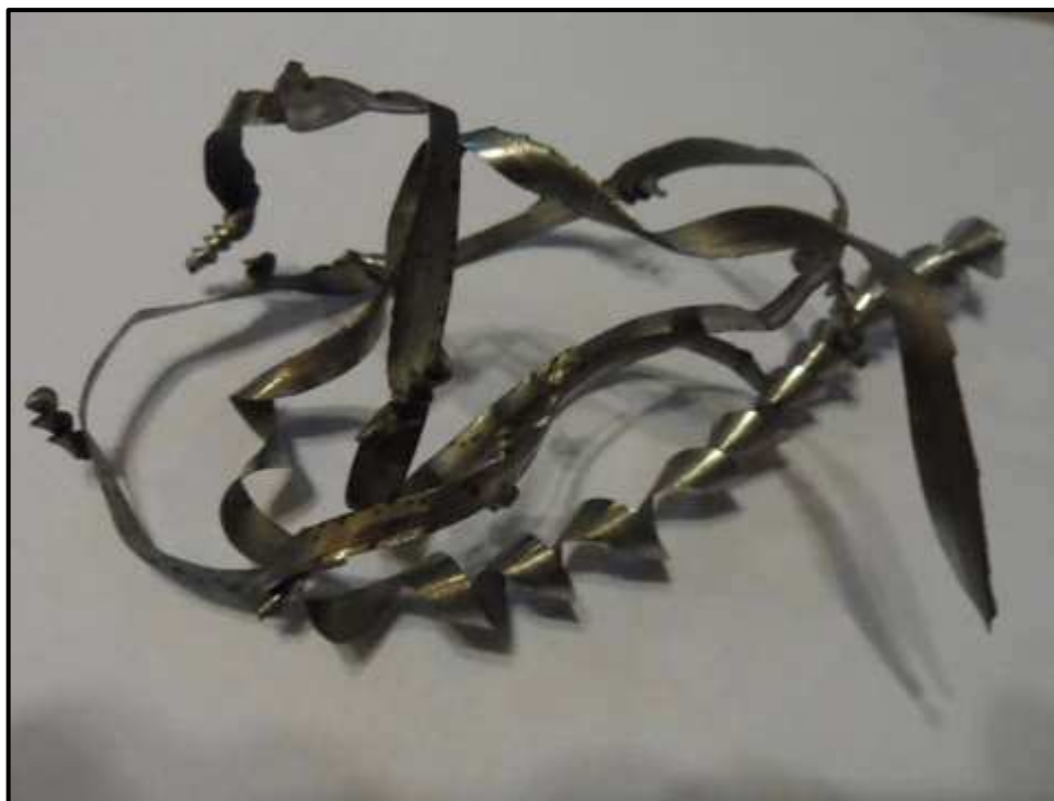
Figura 31 – Cavaco do tipo fita produzido nos ensaios pelas ferramentas que quebraram (sem escala).
