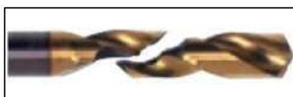
Figura 13 – Quebra da broca (Adaptado de SANDVIK COROMANT, 2006 citado por FORTUNATO, 2012).
