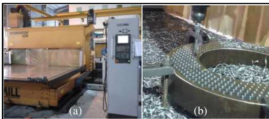
Figura 20 - (a) vista da máquina CNC utilizada nos ensaios. (b) um momento genérico do processo de furação em desenvolvimento.
