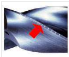
Figura 12 – Trincas no corpo da broca (Adaptado de SANDVIK COROMANT, 2006 citado por FORTUNATO, 2012).
