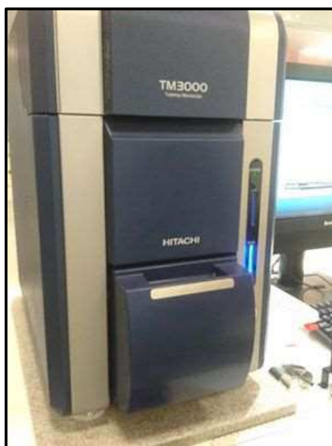
Figura 30 - Vista do microscópio eletrônico de varredura (MEV), marca Hitachi, modelo TM 3000, utilizado para análise do desgaste da ferramenta.
