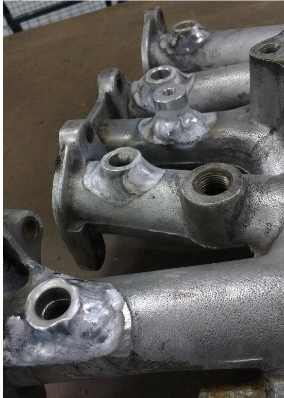
Figura 24 – Solda TIG do Coletor de admissão
