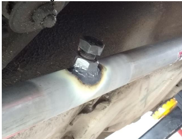
Figura 15 – Solda da Porca
