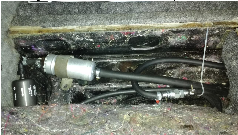
Figura 34 – Bomba e filtro de combustível no porta malas
