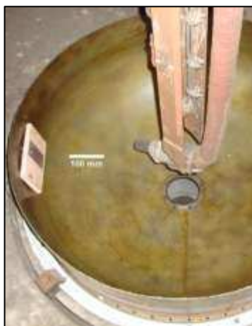
Figura 34 - Dispositivo de ensaio de jateamento utilizado para o equipamento 1 fixado na mesa giratória (Fonte: Autor)
