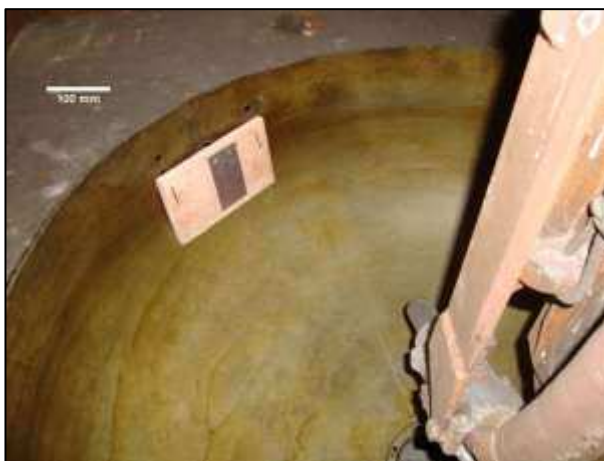
Figura 35 - Detalhe da fixação das amostras no equipamento 1 (Fonte: Autor)
