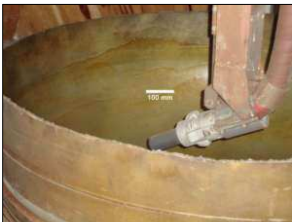
Figura 37 - Detalhe do mecanismo do bico de jateamento pertencente ao equipamento 1 (Fonte: Autor)
