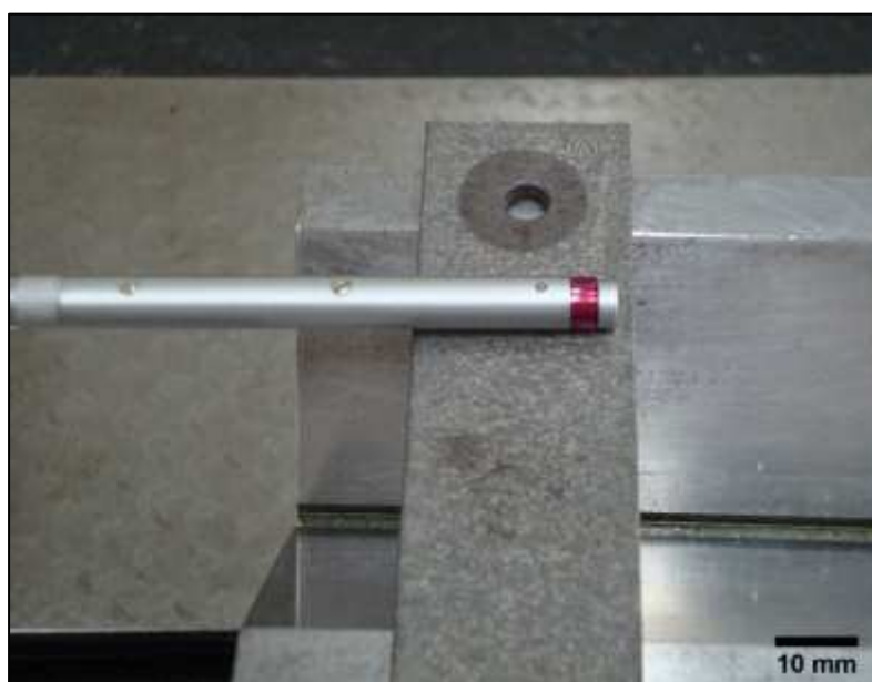
Figura 48 - Apalpador do rugosímetro varrendo a superfície tratada da amostra no seu eixo transversal, onde serão realizadas três medidas de rugosidade com espaçamentos iguais entre elas (Fonte: Autor)
