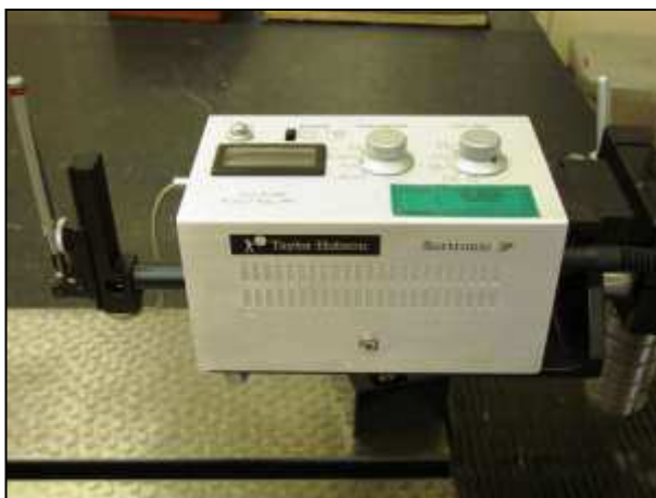
Figura 45 - Modelo de rugosímetro utilizado para a medida da rugosidade superficial nas amostras de aço (Fonte: DCTA/IAE)
