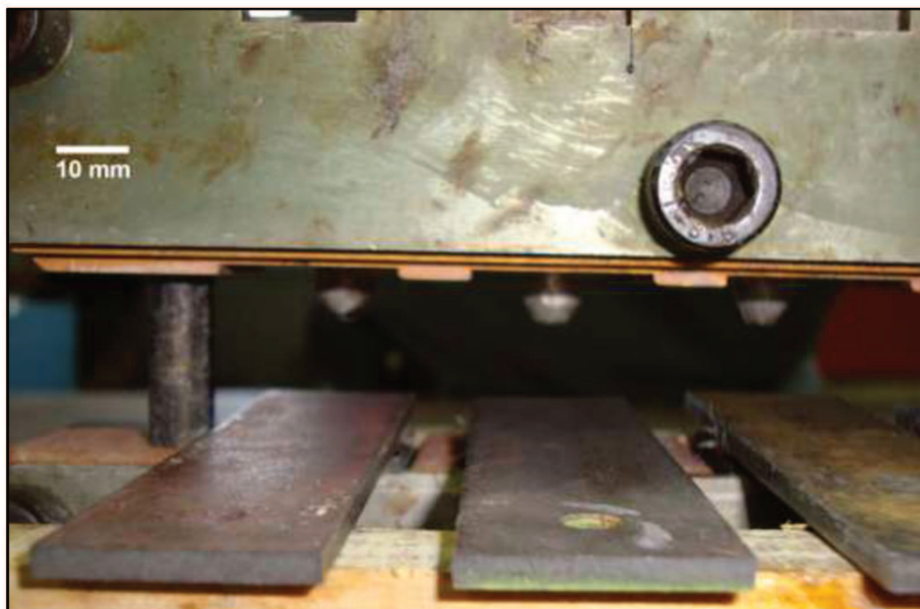
Figura 60 - Detalhe do posicionamento das amostras de aço no dispositivo de colagem (Fonte: Autor)
