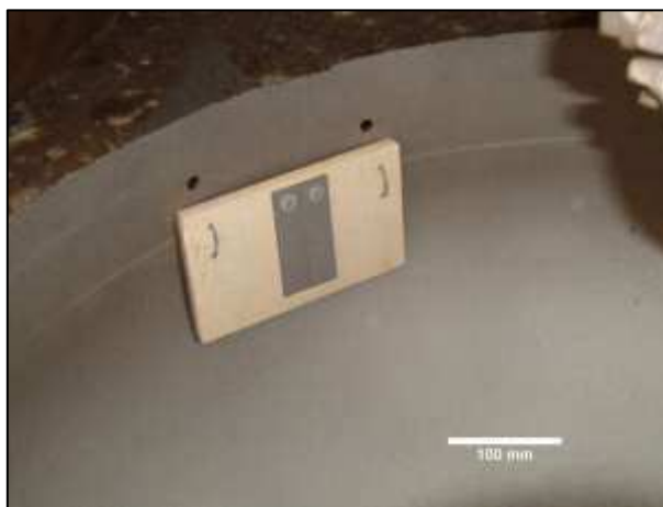
Figura 36 - Amostras de aço 300M-ESR e Maraging 300 sendo jateadas simultaneamente (Fonte: Autor)
