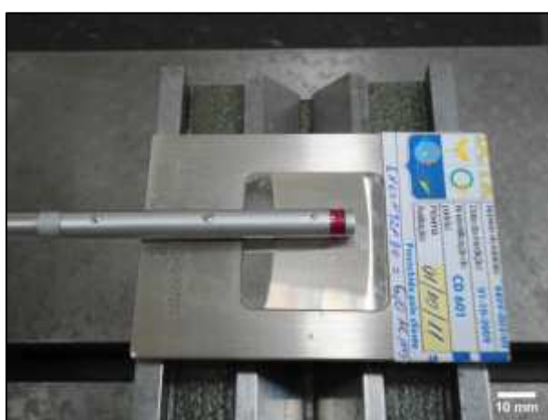
Figura 46- Procedimento de calibração do rugosímetro através de um bloco padrão aferido (Fonte: DCTA/IAE)
