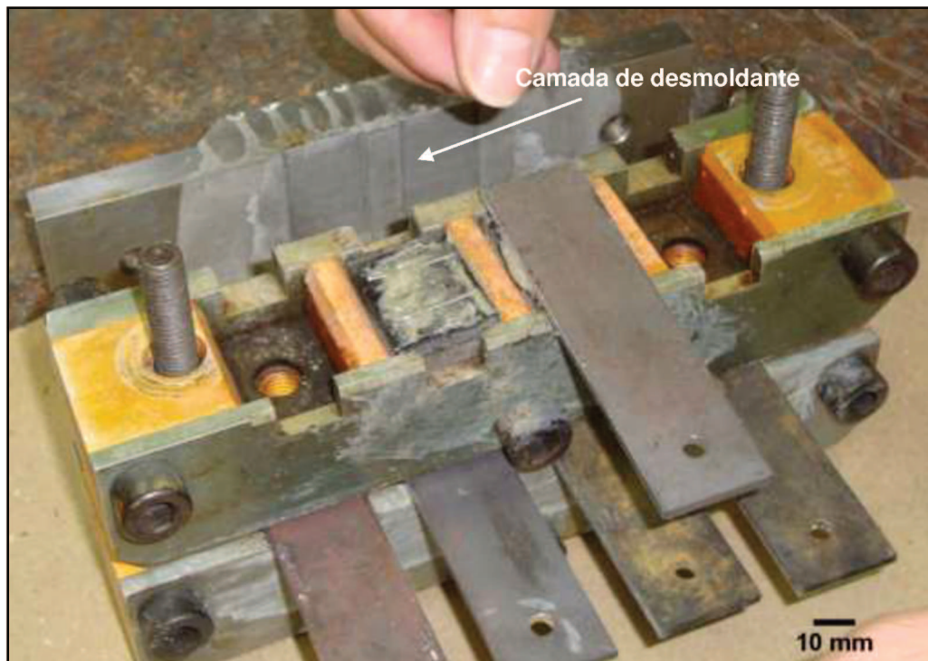
Figura 61 - Detalhe da camada de desmoldante utilizada no dispositivo de colagem (Fonte: Autor)
