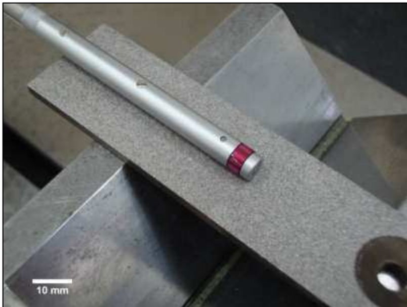
Figura 47 - Apalpador do rugosímetro varrendo a superfície tratada da amostra no seu eixo longitudinal, onde são realizadas as três medidas de rugosidade com espaçamentos iguais entre elas (Fonte: Autor)
