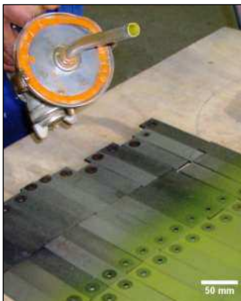
Figura 55 - Aplicação de primer na superfície das amostras de aço após jateamento abrasivo e limpeza com tricloroetano (Fonte: Autor)
