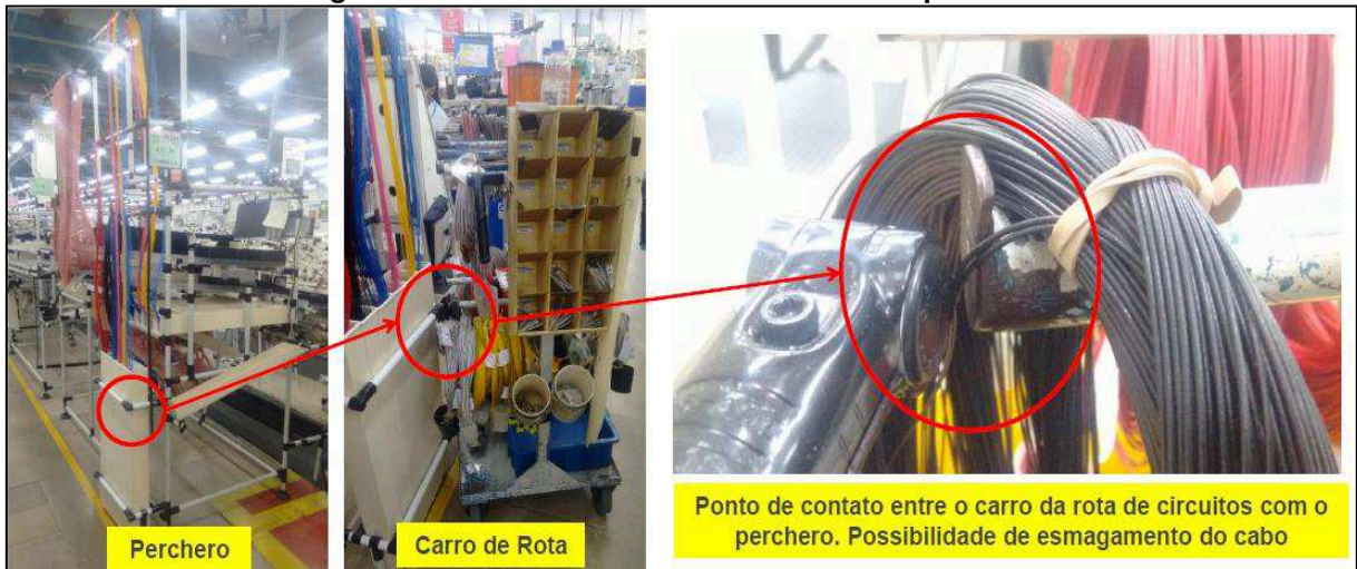
Figura 11 - Ponto de contato da roda com o perchero
