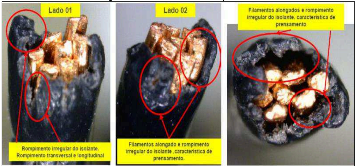
Figura 6 - Características do rompimento
