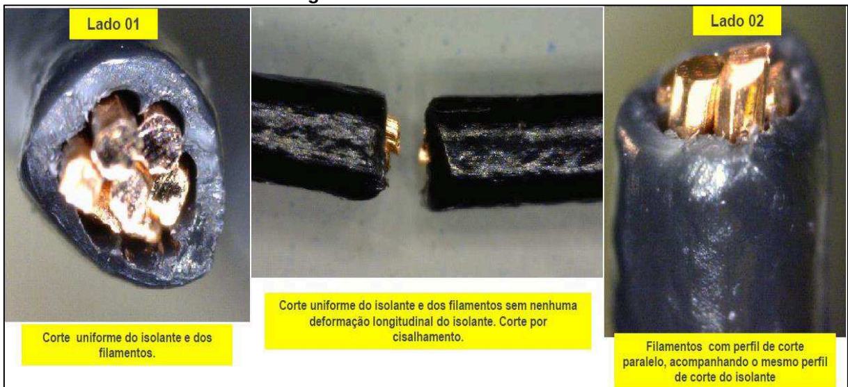
Figura 10 - Corte com tesoura
