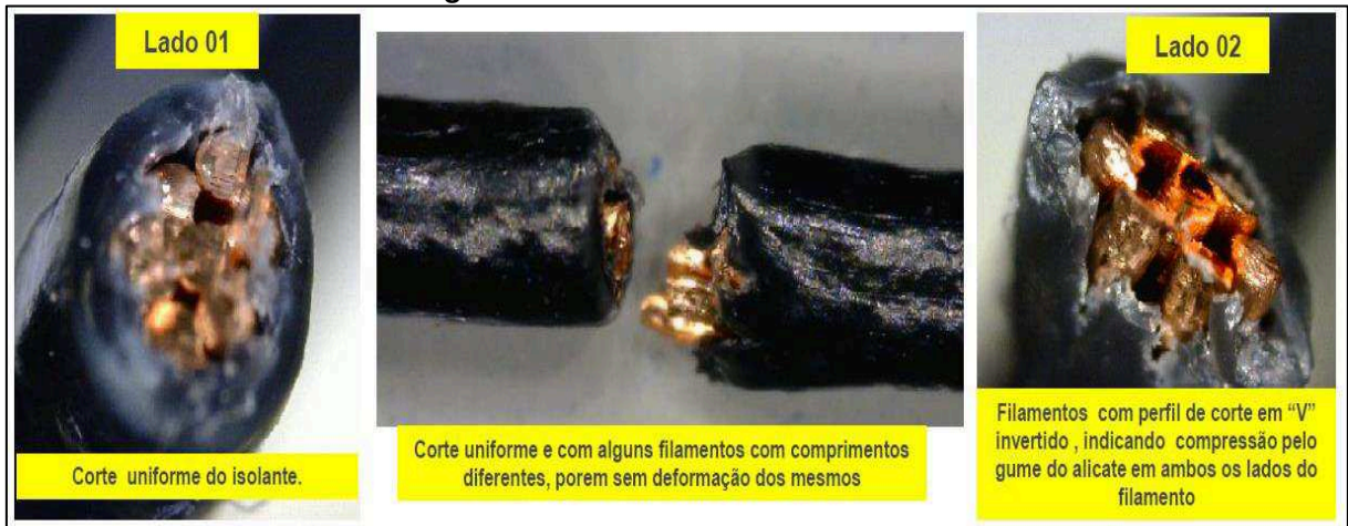
Figura 9 - Corte com alicate de corte
