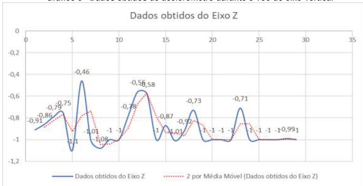
Gráfico 8 - Dados obtidos do acelerômetro durante o voo do eixo vertical
