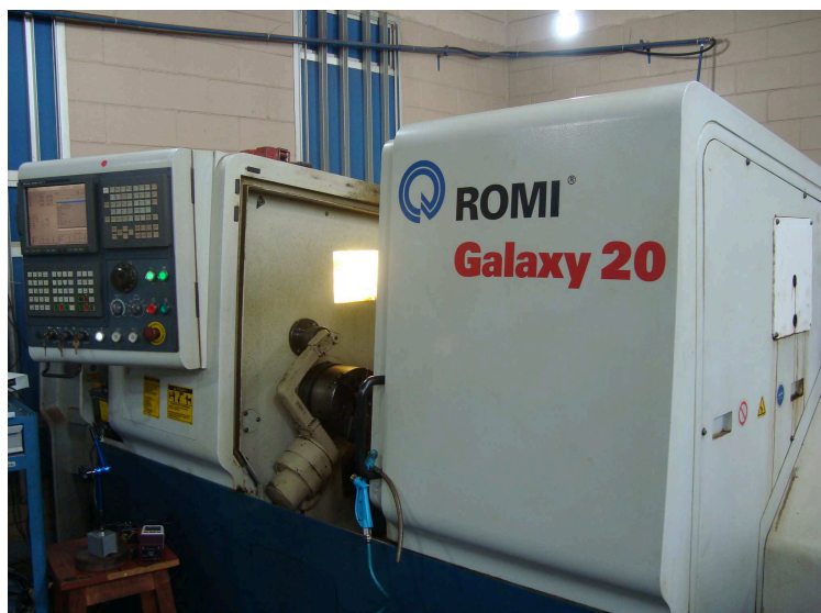
Figura 22 - Torno ROMI Galaxy 20 (LAB/DEMM/FEM/UNICAMP) (Fonte: elaborado pelo autor).
