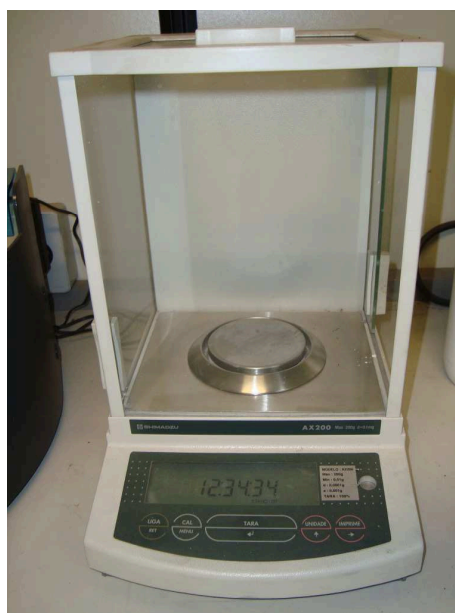
Figura 23 - Balança analítica Shimadzu AX200 (LAB/DEMM/FEM/UNICAMP) (Fonte: elaborado pelo autor),
