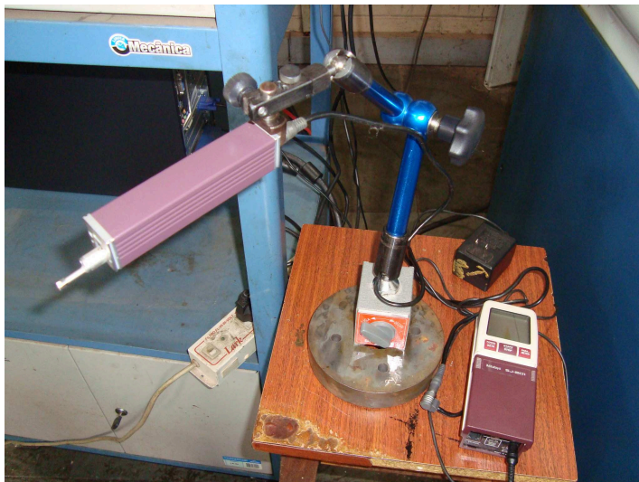
Figura 24 - Rugosímetro Mitutoyo SJ-201 (LAB/DEMM/FEM/UNICAMP) (Fonte: elaborado pelo autor).
