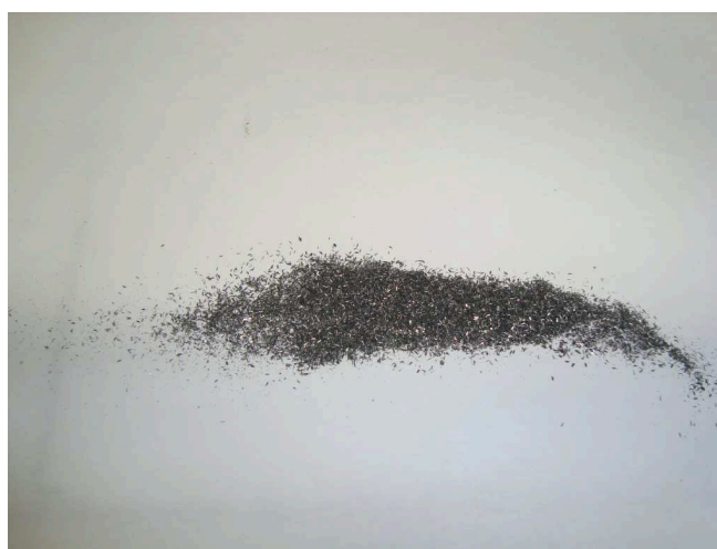
Figura 18 - Cavaco gerado pela usinagem do metal duro H11N (Fonte: elaborado pelo autor).
