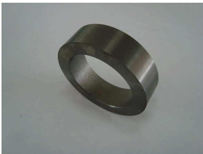
Figura 16 - Corpo de prova de Metal Duro sinterizado H11N (Fonte: elaborado pelo autor).
