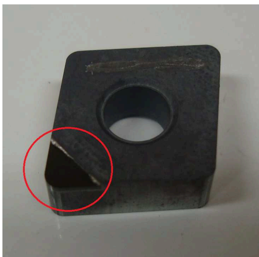
Figura 21 – Foto do inserto mostrando o PCD incrustado no substrato de metal duro (Fonte: elaborado pelo autor).
