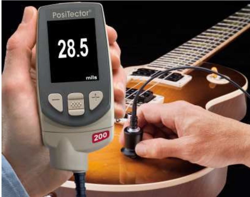
Figura 35 - Instrumento de medição de camada de verniz
