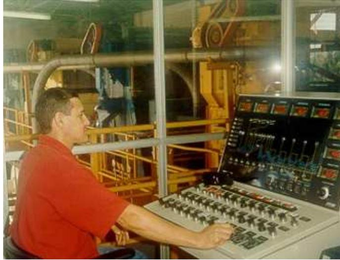
Figura 12 – Mesa de comando e controle das moendas (cortesia: Usina Rafard)
