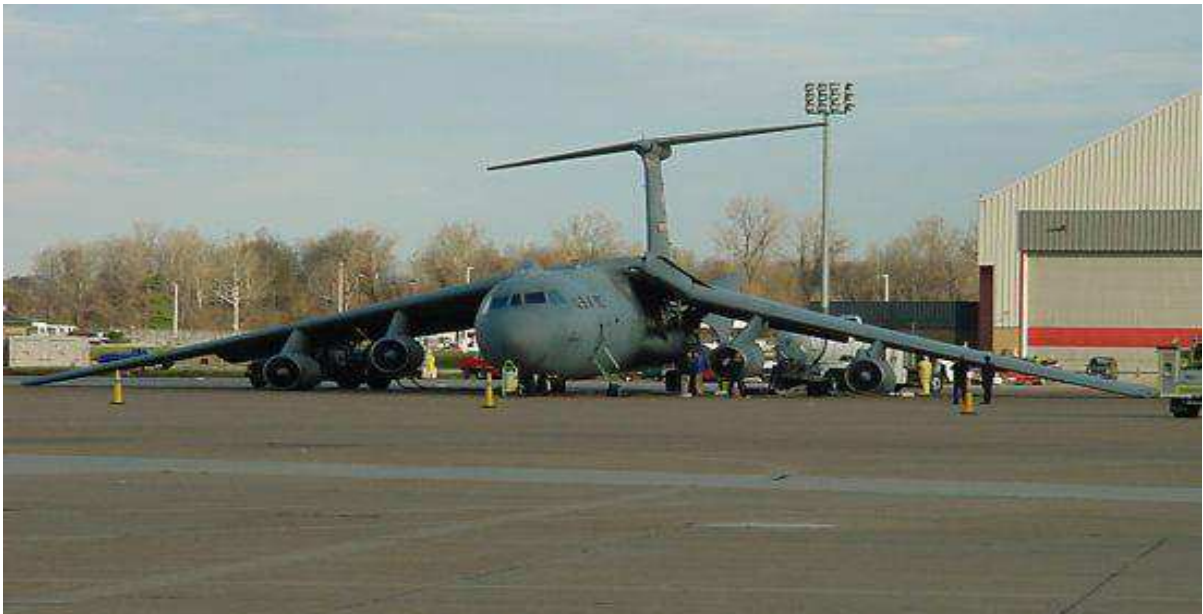
Figura 33. - Sarlifter C141. Com fadiga na Asa. 33
