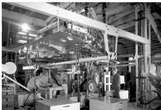
Figura 36. Teste de Fadiga na Asa do MIRAGE III.
