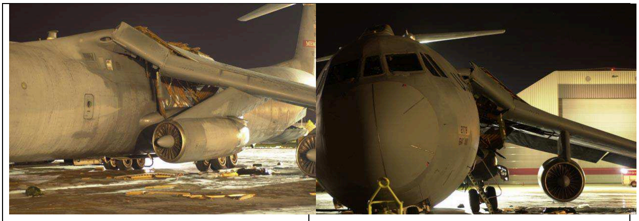
Figura 34. - Sarlifter C141. Com fadiga na Asa.
