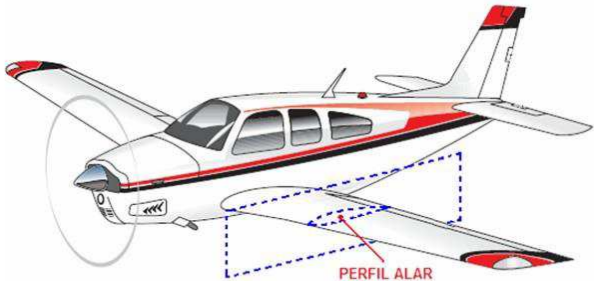
Figura 13. - Perfil do Aerofólio. COMPÊNDIO DE AERODINÂMICA BÁSICA, 14 (2015).
