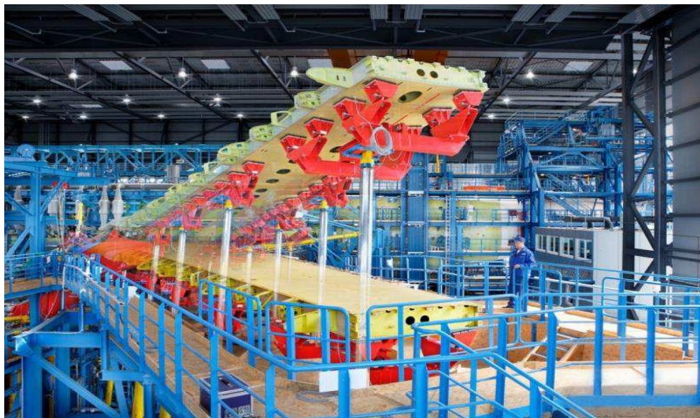
Figura 21. - Ensaio de Fadiga na Asa do Avião, 22 .
