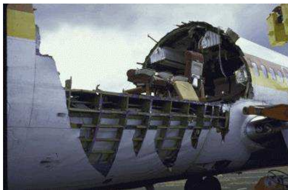
Figura 32. - BOEING 737 com Fadiga na Asa e Fuselagem. (2017).
