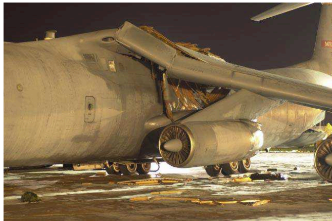
Figura 27. - Fadiga na Asa do Avião STARLIFTER C-141. C141 HEAVEN, 28 (2017).
