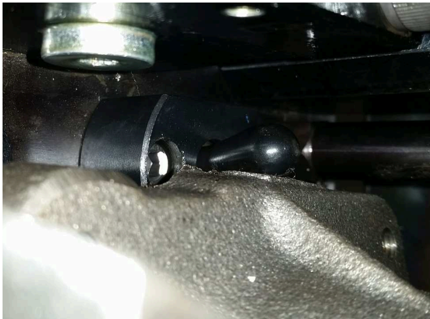
Figura 29 - Gatilho de posicionamento com peça com rebarba. Fonte: Elaborado pelo autor.
