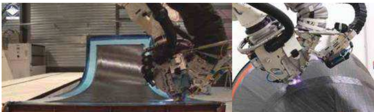
Figure 24: Sistema automatizado de deposição de fibras secas Fonte: GARDINER, 2016.
