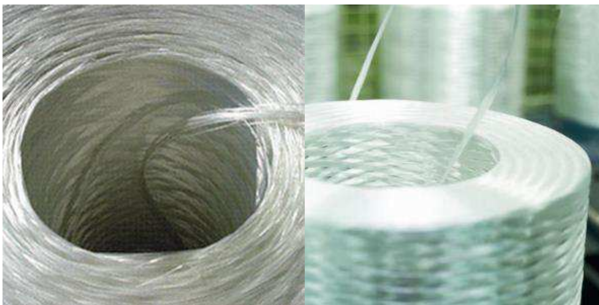
Figura 18: Exemplos de rovings utilizados no mercado. Fonte: http://www.owenscorning.com.br/pt-br
