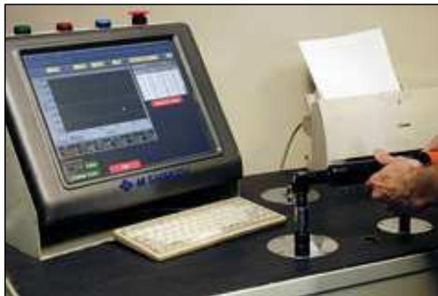
Figura 26 - Procedimento de calibração de Apertadeira. Fonte: (M. SHIMIZU , 2016)
