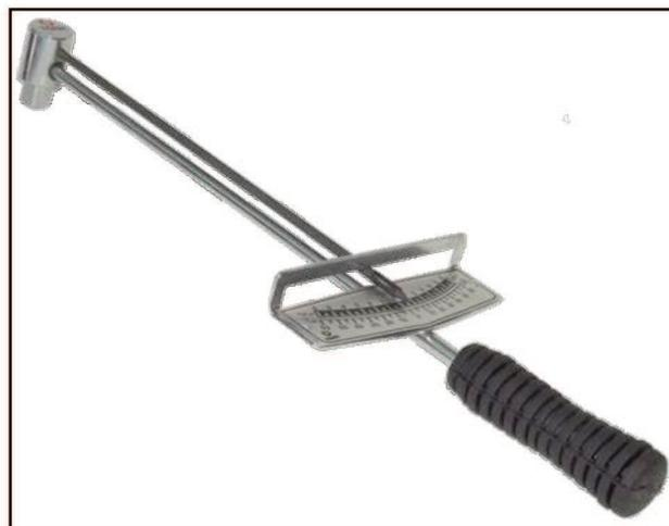
Figura 23 - Torquímetro de Vareta. Fonte: (M. SHIMIZU , 2016)
