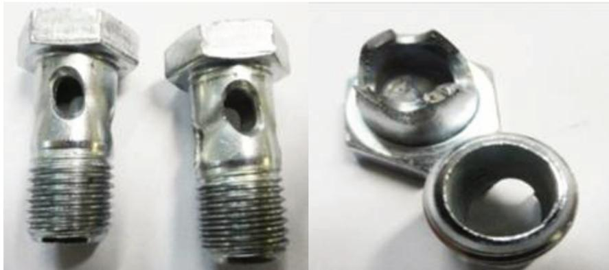
*Figura 10 - Quebra nos furos com 4,5mm de diâmetro, devido alongamento excessivo.
