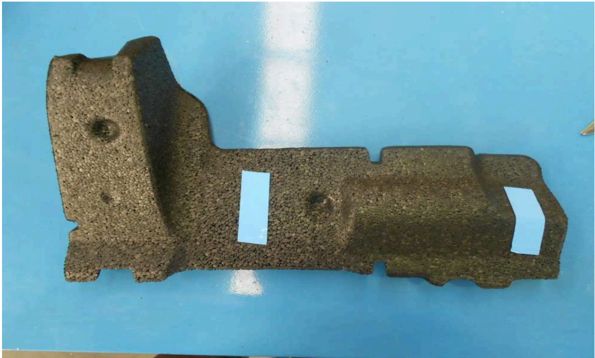
Figura 30 - Antes da melhoria no processo de injeção e resfriamento
