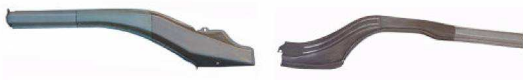
Figura 17 - Longarinas com tailored blank de 3 espessuras
