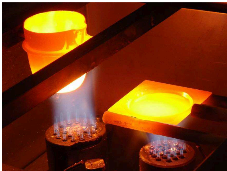
Figura 3.5 - Amostra de pó fluxante sendo fundida na máquina de fusão Vulcan VAA2. (fonte: laboratório da Stollberg do Brasil)
