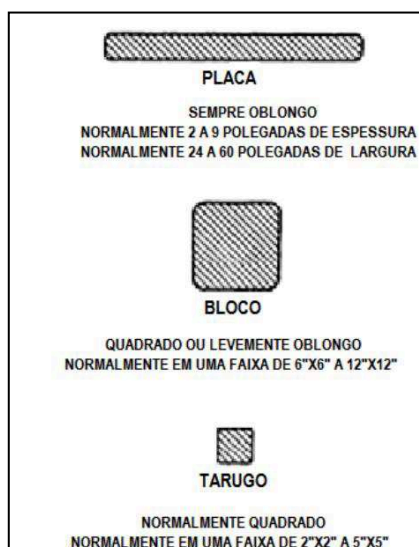
Figura 3.2 - Seções transversais e dimensões típicas dos produtos lingotados. (fonte: SILVA, 2010)
