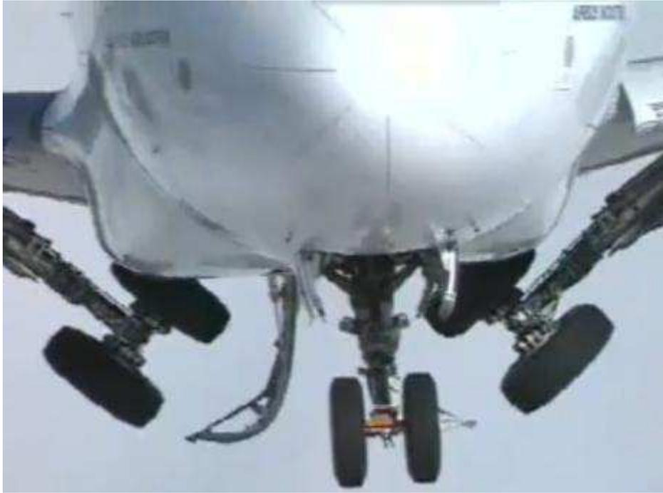
**Figura 40 - Recolhimento dos trens de pouso de uma aeronave Airbus A320 após decolagem (ALBUQUERQUE, 2011)**
