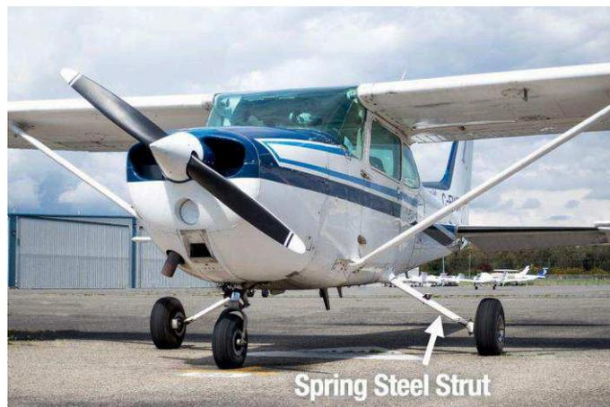
**Figura 6 – Trem de pouso principal do tipo lâmina – Aeronave Cessna 172**
