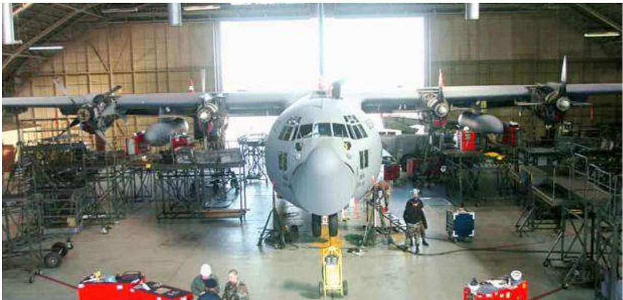
**Figura 30 - Aeronave Lockheed Hercules C-130 suportada por macacos (ALBUQUERQUE, 2011)**
