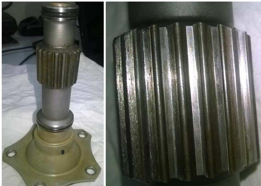
Figure 21. Foto do Input Pinion com sinal de atrito (Elaborado pelo autor)
