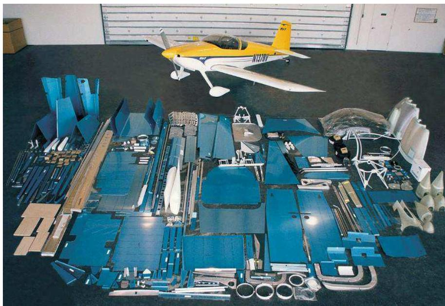
**Figura 8:** Aeronave RV-7 a Frente em Partes e ao Fundo um RV-7 Finalizado
