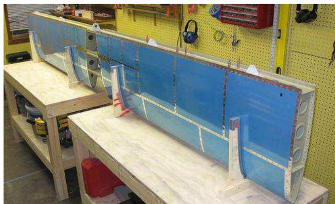
**Figuras 46 e 47:** Montagem Estabilizador Horizontal\_1 e 2
