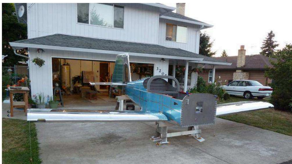
**Figura 6:** Montagem de *Kit* na Garagem.
