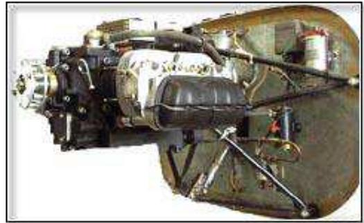
**Figura 1 e 2:** Motores Volkswagen VW Aplicados em Aeronaves Experimentais.
