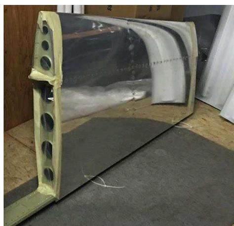
**Figuras 52 a 54:** Montagem Estabilizador Vertical \_1, 2 e 3.
