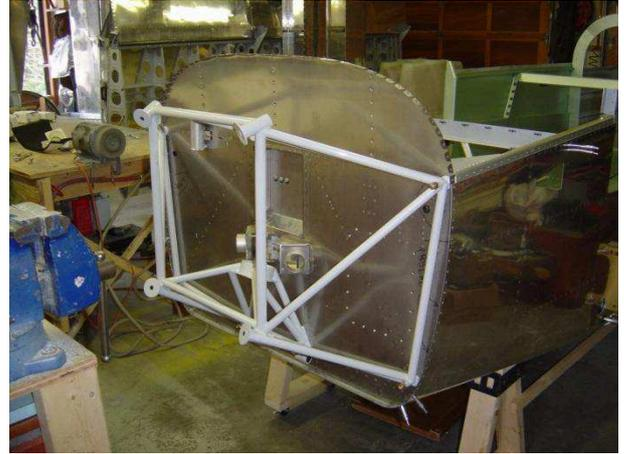
**Figuras 62 e 63:** Montagem da Fuselagem \_5 e 6
