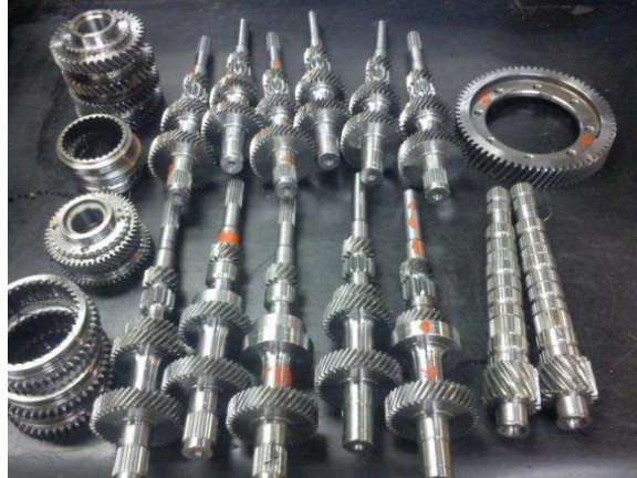
Figura 25 – Peças de refugo a serem utilizadas como corpos de prova.
