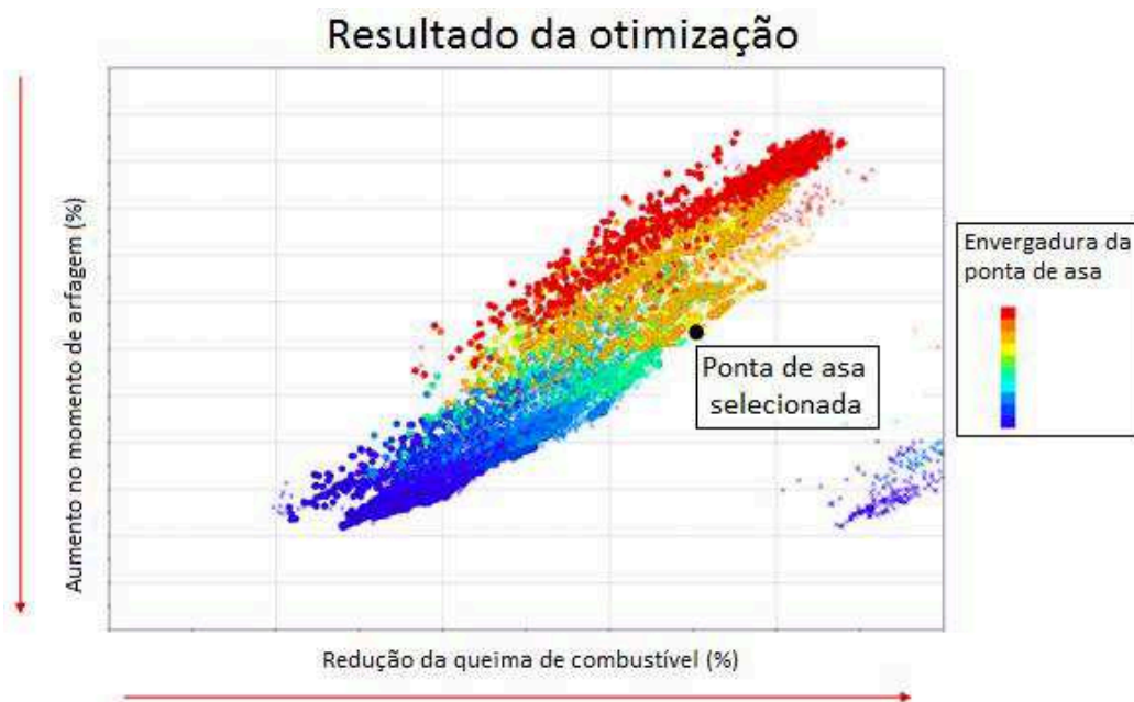
Figura 34. Projeto da nova ponta de asa utilizando a metodologia MDO (Fonte: Modificado de Cavalcanti, 2014)
