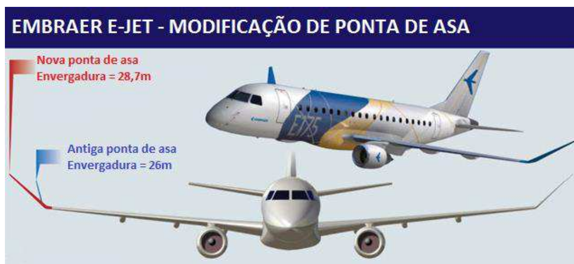
Figura 30. Comparação das configurações de ponta de asa do E175 (Fonte: Modificado de Web 6 )
