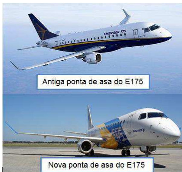
Figura 29. Antiga VS Nova ponta de asa do E175 (Fonte: Modificado de Web 5 )
