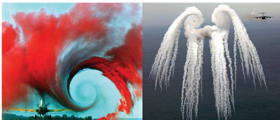
Figura 10. Vórtices devido a variações de velocidade e sustentação
