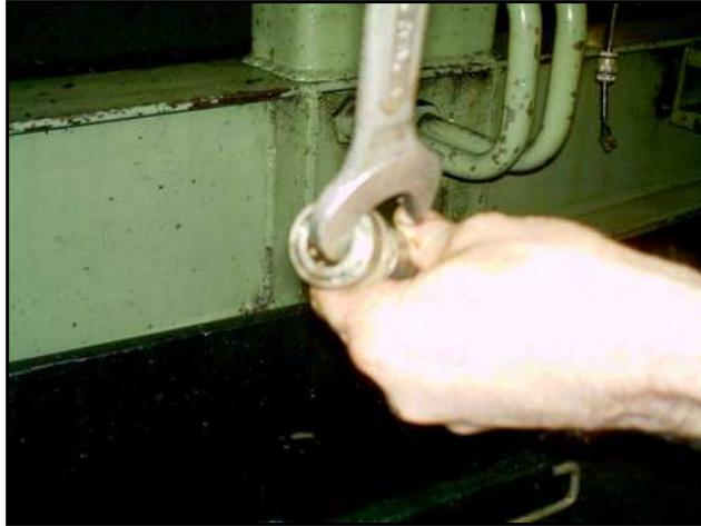
Figura 20 – Aacionamento com chave no engate da mangueira de óleo hidráulico para se eliminar a pressão interna (antes da melhoria). Fonte: Empresa estudada.
