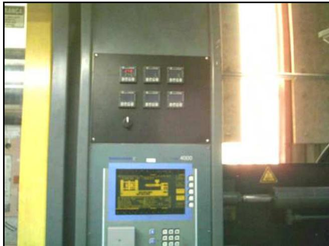
Figura 30 – Painel de controle de temperatura de câmara-quente (após melhoria).
