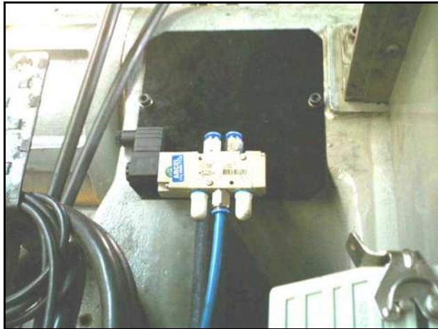
Figura 28 – Válvula pneumática (após melhoria). Fonte: Empresa estudada.
