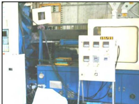
Figura 29 – Painel de controle de temperatura de câmara-quente (antes melhoria).
