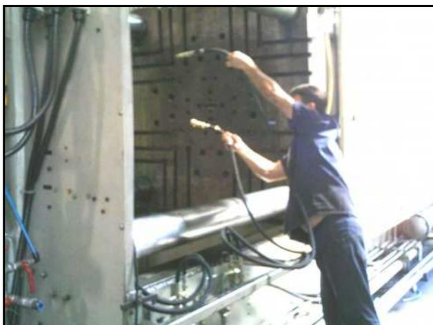
Figura 27 – Trocador manuseando mangueira hidráulica (após melhoria).
