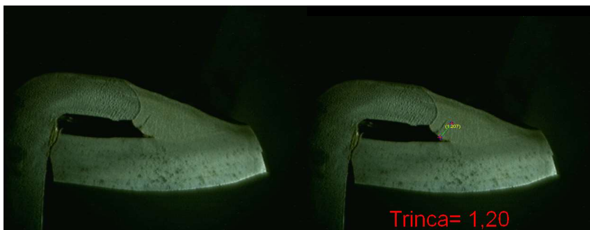
Figura 7 – Trinca na Soldagem da Chapa e da Bucha.
