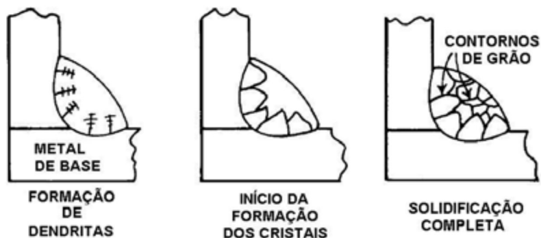
Figura 2 – Processo de solidificação de uma junta soldada. Fonte: (Fortes et. al. 2005).
