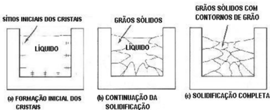
Figura 1 – Processo de Solidificação dos Metais. Fonte: (Fortes et. al. 2005).
