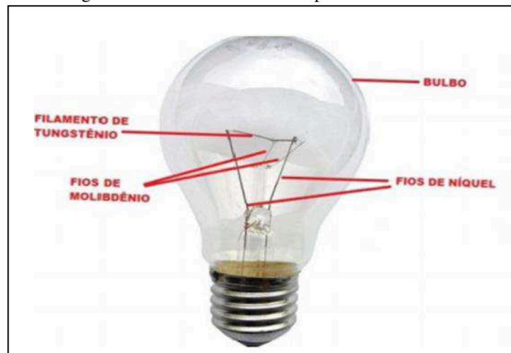
Figura 13– Estrutura de uma lâmpada incandescente
