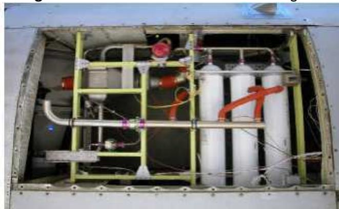
Fonte: Simplified Fuel Tank Inerting System.
