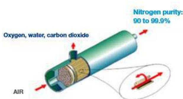
Fonte: FOCUS N°2 FUEL TANK INERTING, 2010.
