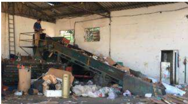
Figura 6 – Imagem ilustrativa da Prensa, equipamento usado para enfardamento.
