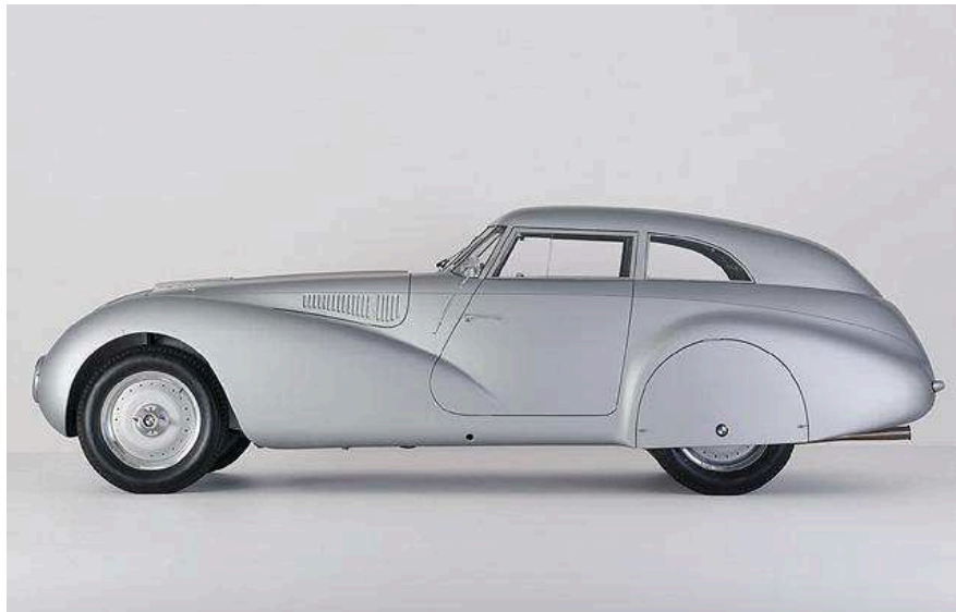
Figura 2: Veículo baseado na proposta de Kamm
