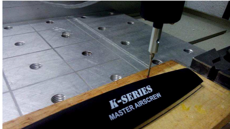
Figura 15 – Equipamento fazendo a leitura tridimensional da pá Fonte – Elaborado pelo autor
