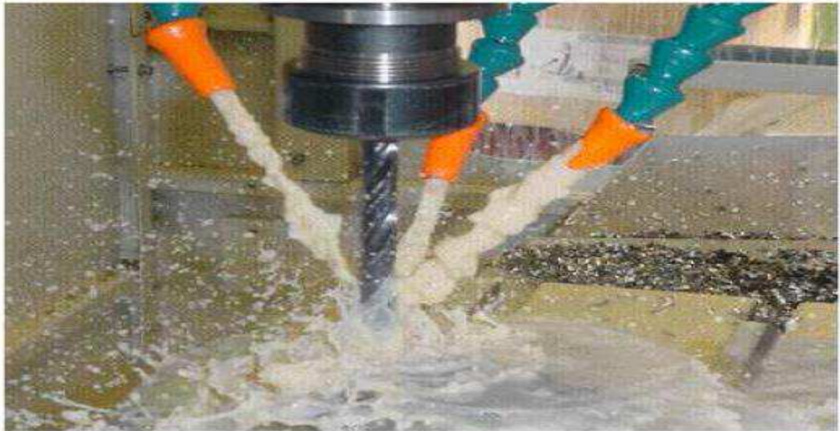
Figura 3 - Utilização por jato de fluido de corte semissintético, com um total de escoamento de 1230 l/h.
