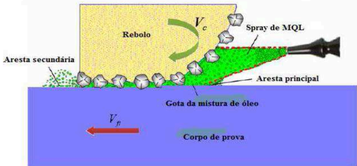
Figura 6 - Apresenta como funciona o método de MQL no procedimento de retificação.
