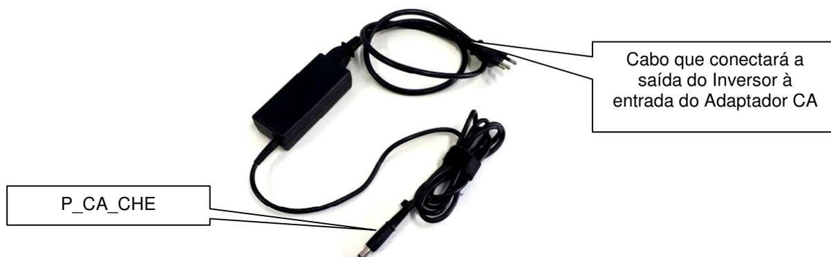
Figura 4.3 – Adaptador CA para *notebook* modelo HP Pavilion G4 - com indicação do P\_CA\_CHE
